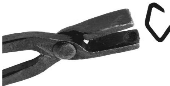
Ringtang met holletjes aan de binnenkant waar de ring in paste zodat die niet weg kon glijden. Deze tang is gesmeed door H.P. Eltink.
