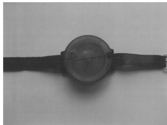
Kompas ingebouwd in een leren polsarmband, bevestigd met een klikveerverbinding. Mogelijk was dit kompas ook te plaatsen in een houder in de Biber.
