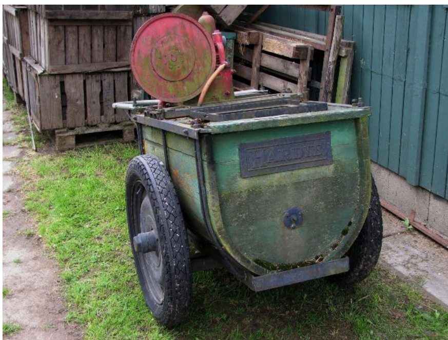
Dit souvenir van vroeger zagen we bij de historische tuin in Lent; deze oude Hardie motorspuit om struiken en fruitbomen te bespuiten tegen schimmels en insecten
